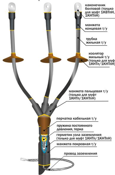
1. Проверьте соответствие муфты сечению жил, типу, рабочему напряжению кабеля и подготовьте его для разделки.
